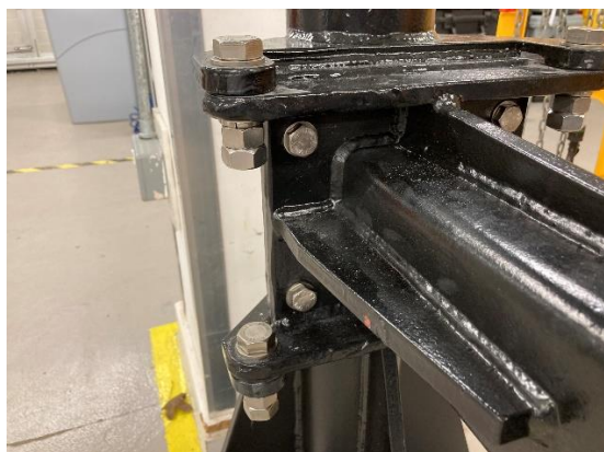
Figura 19 Pernos de montaje del brazo de radar.
