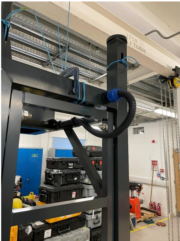
Figure 15 Swing arm cable conduit .
