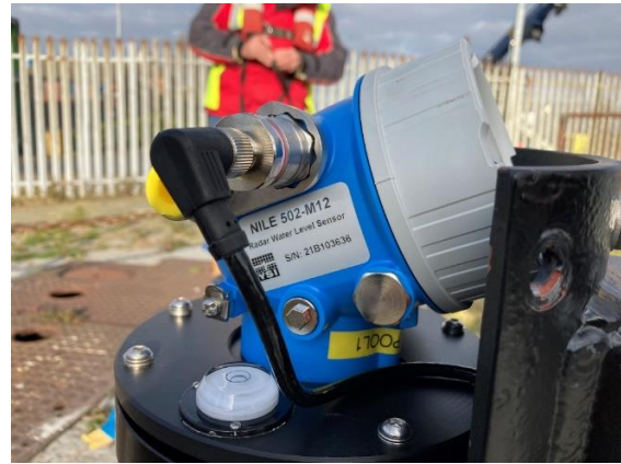
Figura 24 Sensor de radar que muestra el nivel de burbuja y los tornillos de ajuste.
