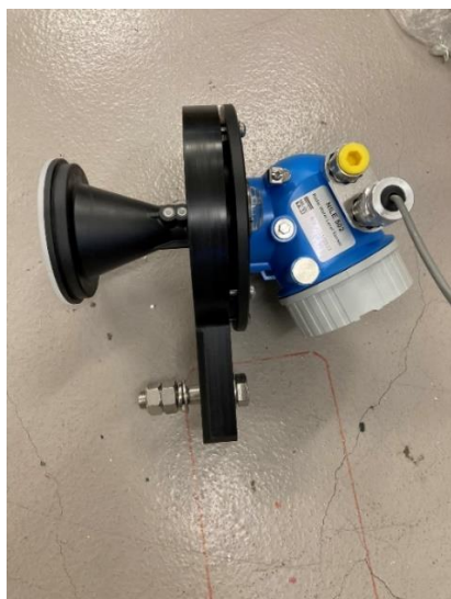
Figura 21 Sensor de radar conectado a la abrazadera de montaje.
